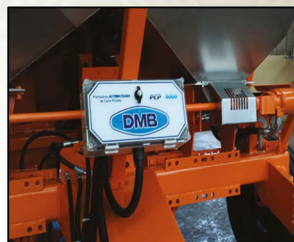
CLP onde todas as operações da plantadora são programadas eletronicamente
