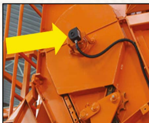
Encoder que mede a velocidade das esteiras
